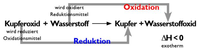
Wasserstoff ist ein *Reduktionsmittel*, da es das Kupferoxid *reduziert* (ihm den Sauerstoff *entzieht*). Reduktion und Oxidation kommen immer gemeinsam vor. In der Klasse 9 steht die Oxidation für die Sauerstoffaufnahme, die Reduktion für die Abgabe von Sauerstoff. Welche Definition ist denn die umfassendere (und für uns geltende)?
